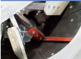
Schmutzunempfindlicher Abstreifer aus verschleißfestem Stahl (Hardox400), der die Durchlaufmischerwand von anhaftendem Material befreit.
