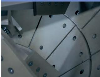
Gusskachelauskleidung des Durchlaufmischers in Material G-X350 CrMoNi 2021, 25 mm stark
