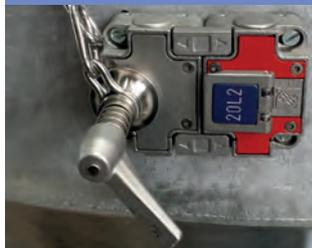
Riegelschloss am Durchlaufmischerdeckel und im Lastteil des Durchlaufmischers im Schaltschrank. Der Schlüssel zum Öffnen vom Riegelschloss am Durchlaufmischerdeckel kann am Riegelschloss im Schaltschrank nur dann abgezogen werden, wenn der Durchlaufmischer spannungslos geschaltet ist.
